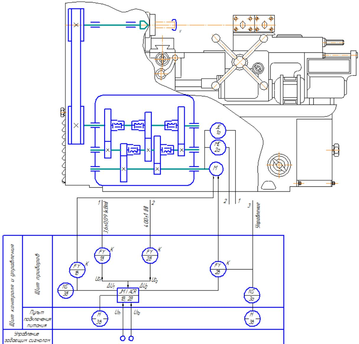
Рис. 47. Совмещенная функциональная схема автоматизации и контроля мощности и крутящего момента при течении
