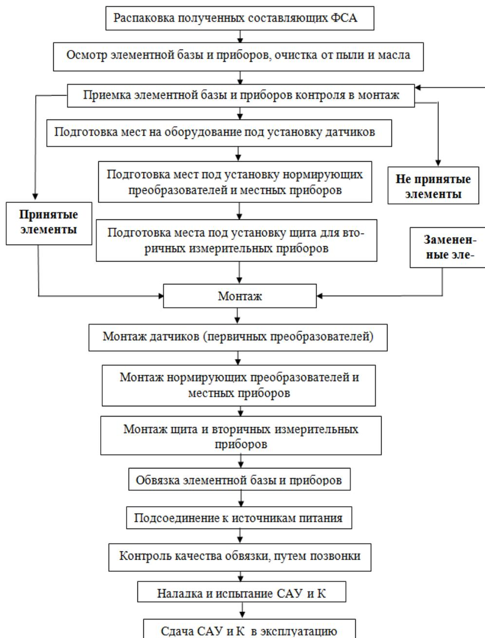
Рис. 59. Схема ТП монтажа системы автоматического управления
