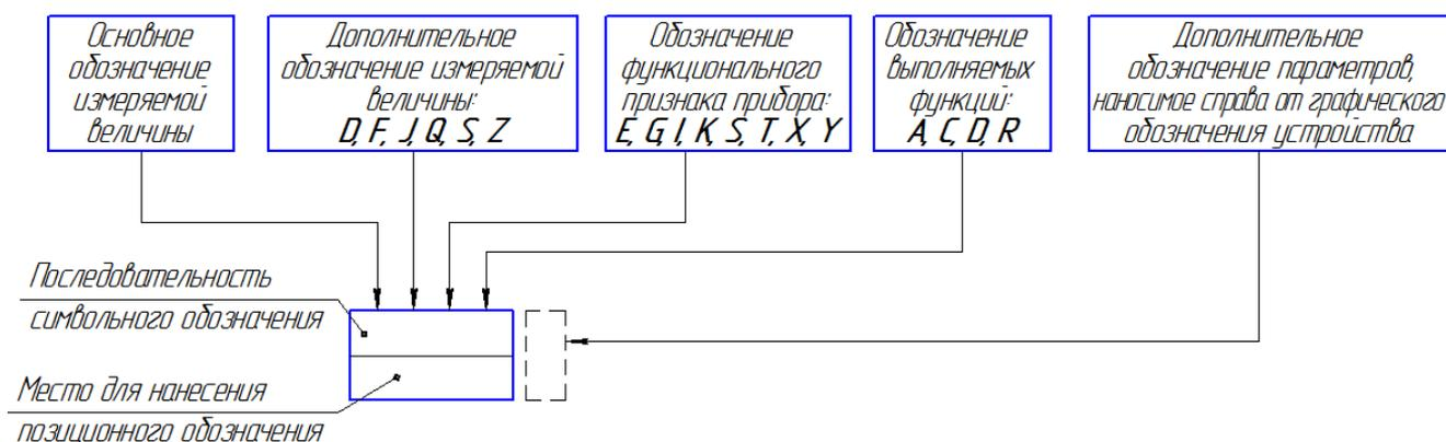
Рис. 1. Принцип построения условного обозначения прибора
