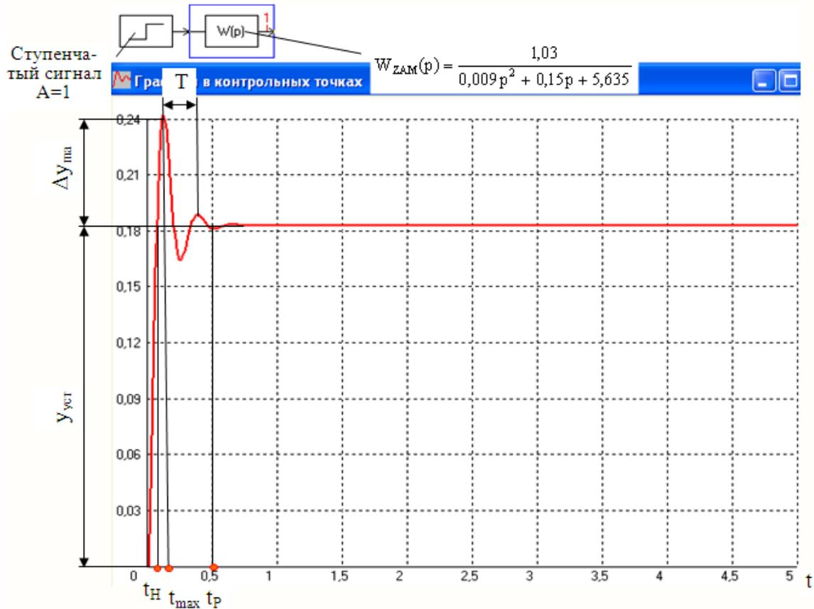
Рис. 41. Определение параметров качества скорректированного процесса управления. Временная функция САУ после установки регулятора  $W_{РЕГ} = 0,5p$
