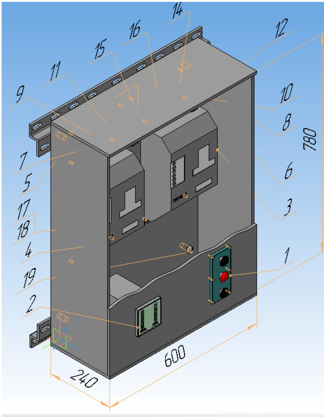
Рис. 55. 3D модель щита контроля и управления САУ с двумя регулируемыми параметрами
