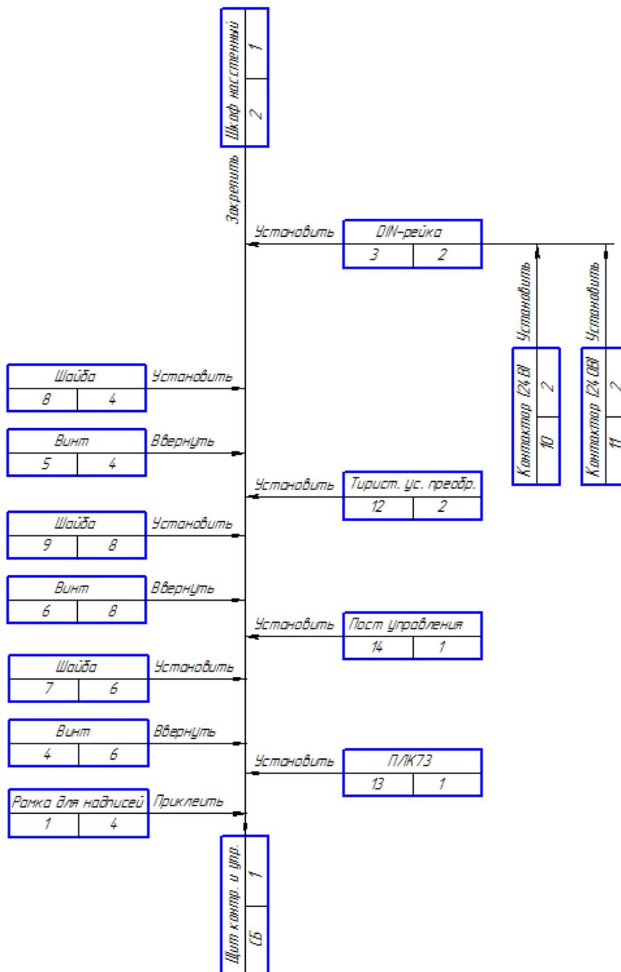
Рис. 58. Технологическая схема сборки щита контроля и управления
