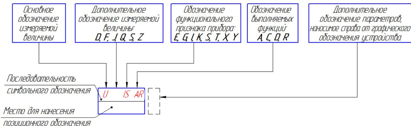
Рис. 3. Принцип построения условного обозначения контроллера промышленного ПАЗ «БАЗИС-21» в соответствии с ГОСТ 21.208-2013
