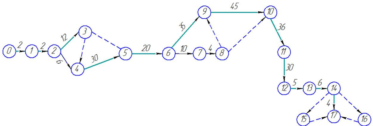
Рис. 6. Сетевая модель графика проведения работ при оснащении технологического оборудования САС
