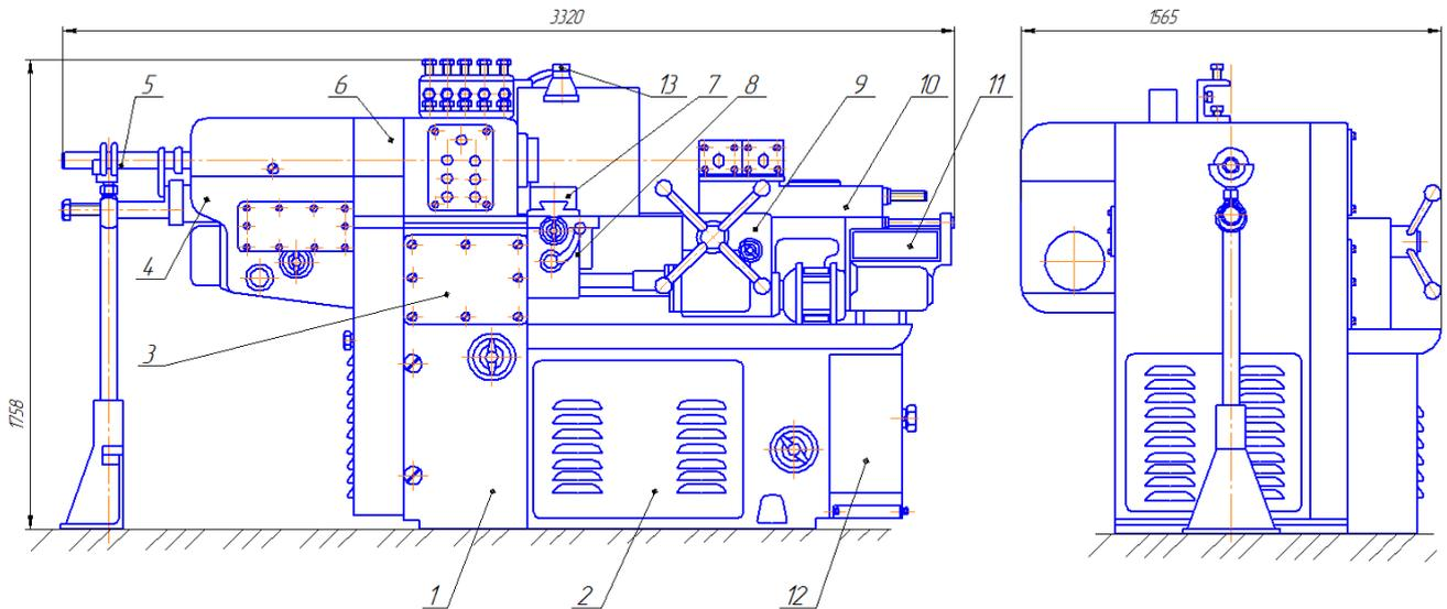
Рис. 7. Станок токарно-револьверный мод. 1П326
