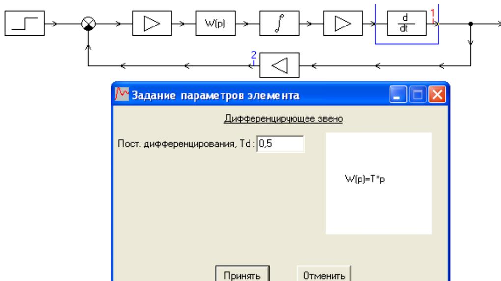
Рис. 40. Установка форсирующего (дифференцирующего) регулятора  $W_{\text{РЕГ}} = 0,5p$
