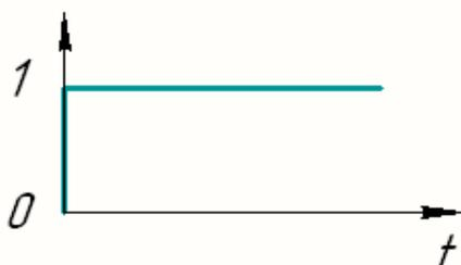
Рис. 37. Единичное ступенчатое воздействие
