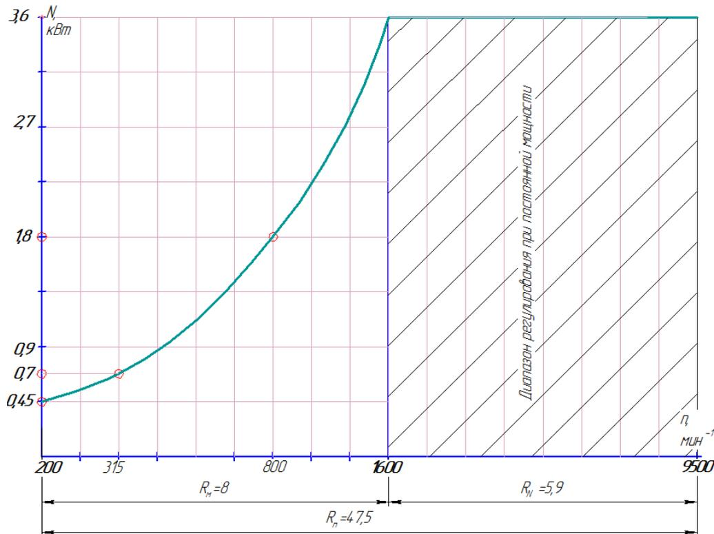
Рис. 44. Зависимость мощности от частоты вращения шпинделя
