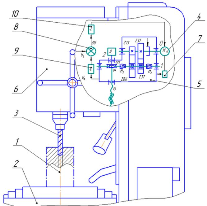
Рис. 11. Технологическая схема системы автоматической стабилизации крутящего момента при сверлении для сверлильного станка мод. 2Н125Ф2
