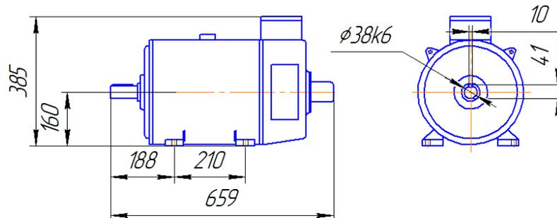
Рис. 52. Габаритные и присоединительные размеры электродвигателя постоянного тока 4ПБМ160МГ
