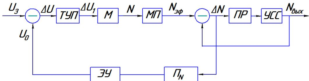
Рис. 15. Структурная схема системы автоматической стабилизации мощности при точении: ТУП – тиристорный усилитель-преобразователь; М – электродвигатель постоянного тока привода подачи; МП – механическая часть ПГД (привода главного движения); ПР – процесс резания; УСС – упругая система станка;  $\Pi_N$  – преобразователь мощности; ЭУ – электронный усилитель.
