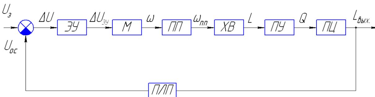
Рис. 23. Структурная схема системы автоматического управления выдвигением руки робота: ЭУ –электронный усилитель; М – электродвигатель постоянного тока; ПП – привод подач; ХВ – ходовой винт; ПУ – пневмоусилитель золотниковой типа; ПЦ – пневмоцилиндр; ПЛП –преобразователь линейного перемещения
