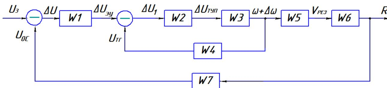
Рис. 22. Модель системы автоматической стабилизации скорости резания при обработке конических поверхностей: W1 (ЭУ – электронный усилитель); W2 (ТУП – тиристорный усилитель-преобразователь); W3 (М – регулируемый электродвигатель); W4 (ТГ – тахогенератор); W5 (ПГД – привод главного движения); W6 (П – преобразователь изменяющегося значения радиуса  $rR$ ); W7 (ПЛП – преобразователь линейного перемещения в электрический сигнал)
