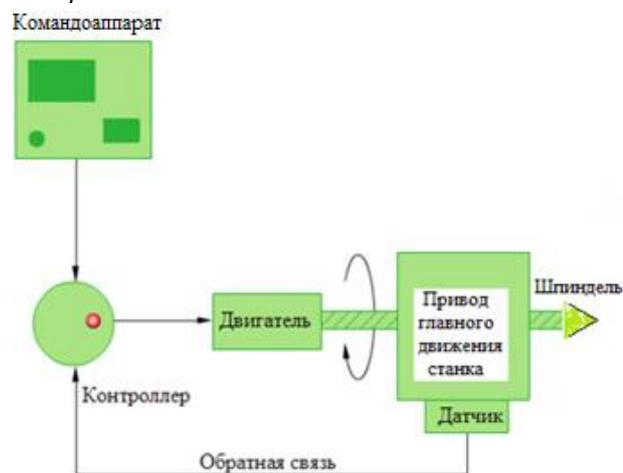
Рис. 46. Схема выполнения ПЛК функции сравнивающего устройства
