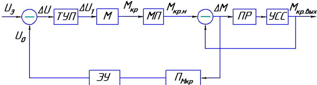
Рис. 17. Структурная схема системы автоматической стабилизации крутящего момента при тчении: ТУП – тиристорный усилитель-преобразователь; М – электродвигатель постоянного тока привода подач; МП – механическая часть ПГД (привода главного движения); ПР – процесс резания; УСС – упругая система станка;  $\Pi_{\text{Мкр}}$  – преобразователь крутящего момента; ЭУ – электронный усилитель.
