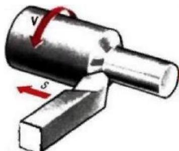
Рис. 42. Процесс точения
