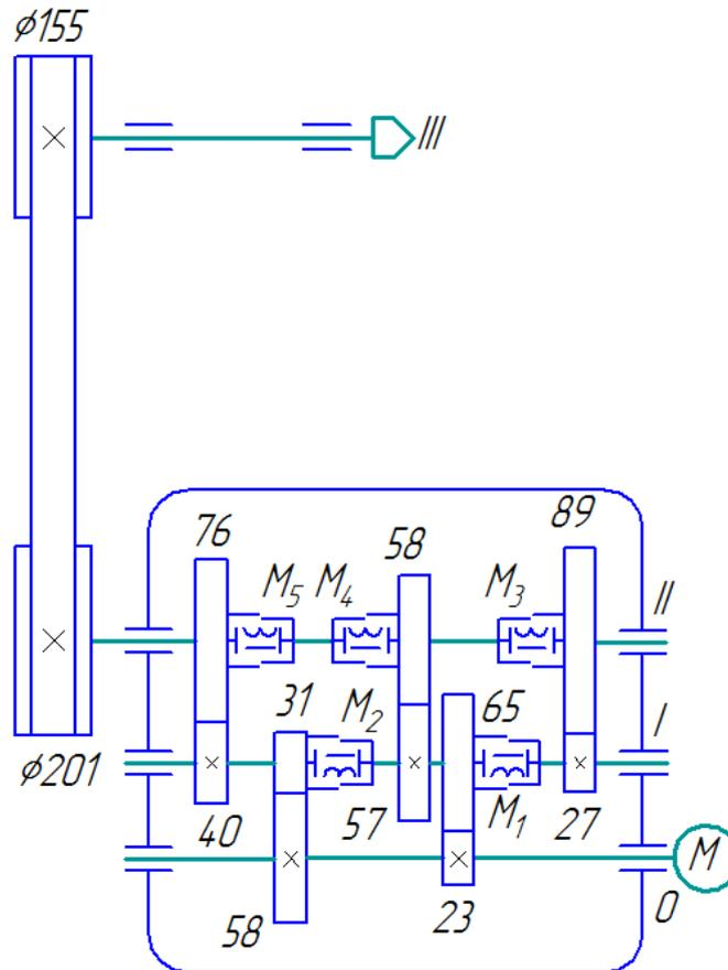
Рис. 43. Кинематическая схема ПГД токарно-револьверного станка мод.1П326
