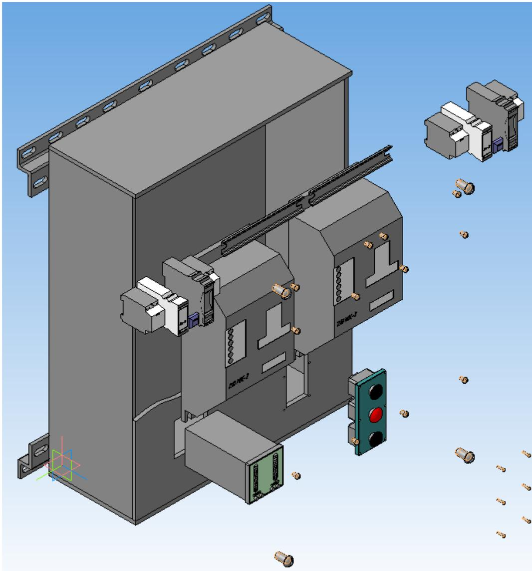
Рис. 56. Разнесенная модель щита контроля и управления САУ с двумя регулируемыми параметрами
