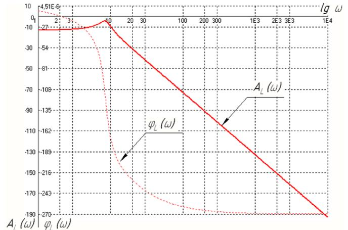
Рис. 30. Пример совмещенных логарифмических характеристик ЛАЧХ и ЛФЧХ
