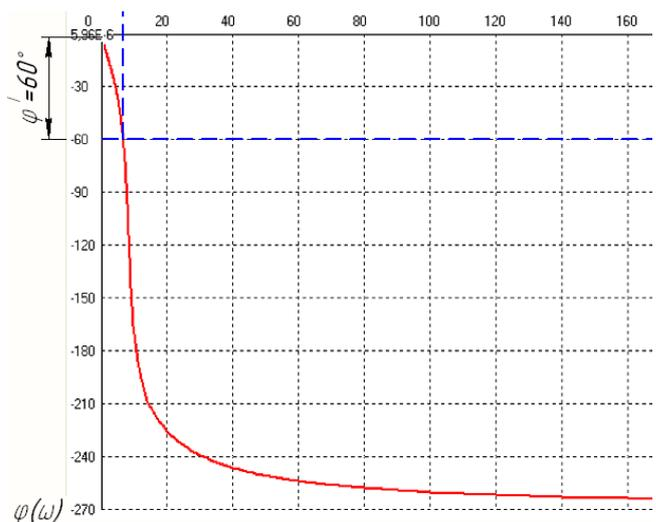
Рис. 28. Пример фазовой частотной характеристики (ФЧХ) и связь ее с АФЧХ
