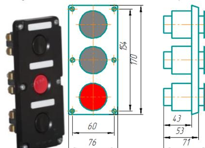
Рис. 54. Внешний вид, габаритные и присоединительные размеры Поста управления ПKE-112-3
