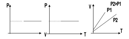
Нетрудно определить, что изобаре в осях V,T имеющей меньший угол наклона к оси температур соответствует большее давление.
