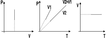
Нетрудно определить, что изохоре в осях Р,Т имеющей меньший угол наклона к оси температур соответствует больший объём.
